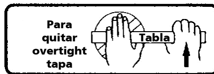
Figura 5- Utilice un curioso barra o tabla como mostrado para quitar o apretar la cobertura de trampa
