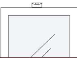
**Step. 3** Remove protective liners. Place level on top to ensure wall item is level. **Étape 3.** Retirer la pellicule protectrice de chaque bande. Placer le niveau sur le dessus de l'article à accrocher et placer le contre le mur. **Paso 3.** Retirar el papel protector de cada tira. Colocar el nivel en la parte superior del artículo a colgar y colocarlo contra la pared.
