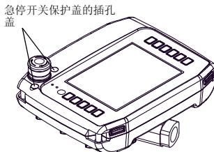
3 将急停开关保护盖的三个螺钉孔与 XBTGH 设备的开孔对齐。用螺钉扣紧 XBTGH 设备前面板的两处开孔与后面板的一处开孔。
