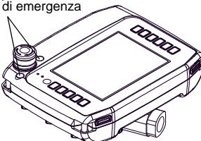
3 Allineare i tre fori per le viti della protezione del tasto di emergenza con i fori delle viti dell'unità XBT GH.
